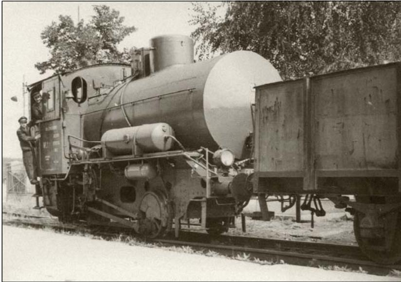
Die Werksbahn („Bullo“) hatte eine feuerlose Lokomotive und fand Anschluss an das Gleisnetz der Halle-Hettstedter Eisenbahn. (Foto: R. Friedrich)
